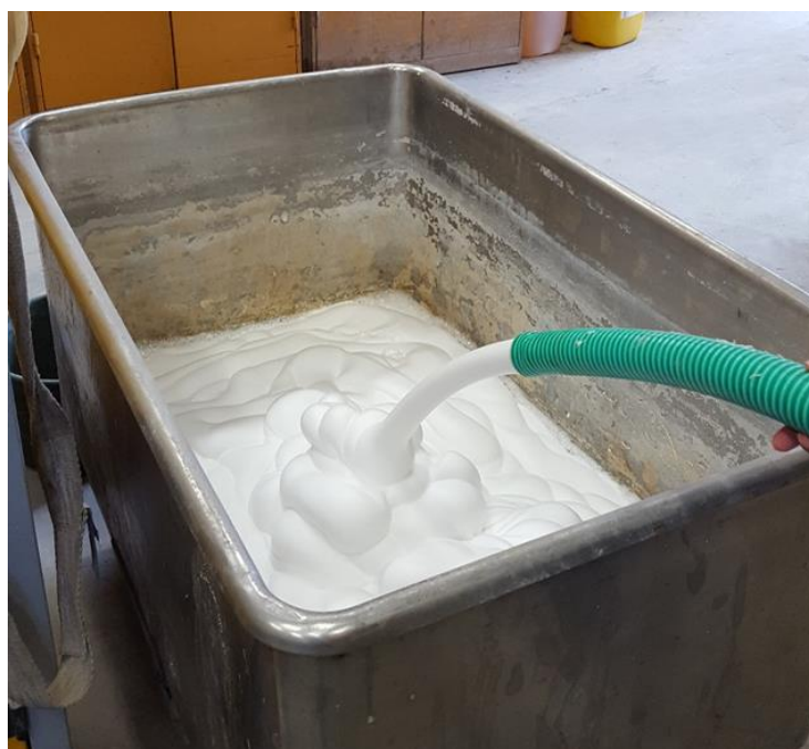
Figur 2 Skum av Aercell A-7 som tillsattes betongen.
