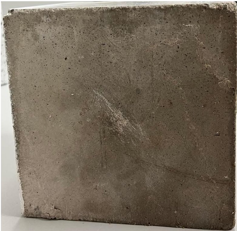
Figur A3.23: Tryckhållfasthetstest utförd på referensprov 3.
