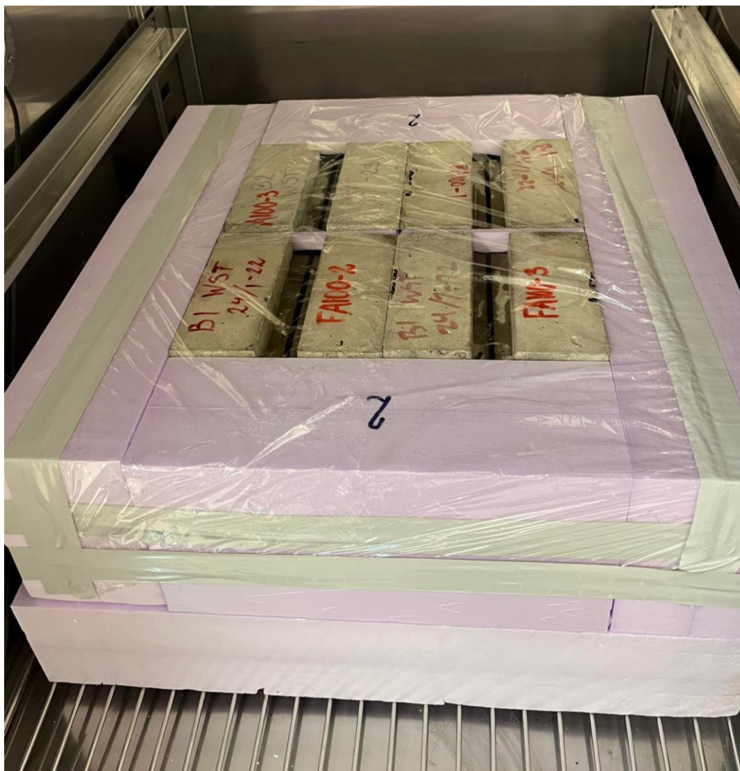
Figur 3.6: Isolering av cellplast och tätning med plastfolie.
