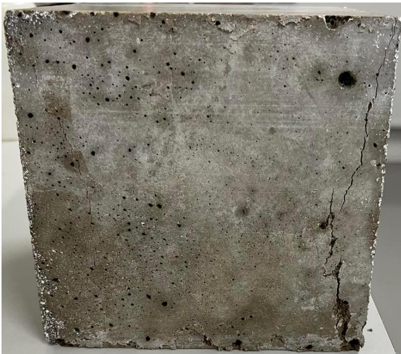
Figur A3.25: Tryckhållfasthetstest utförd på referensprov 4.
