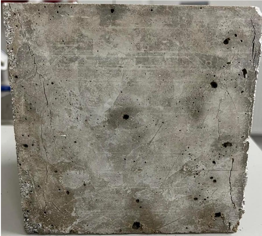
Figur A3.30: Tryckhållfasthetstest utförd på referensprov 5.
