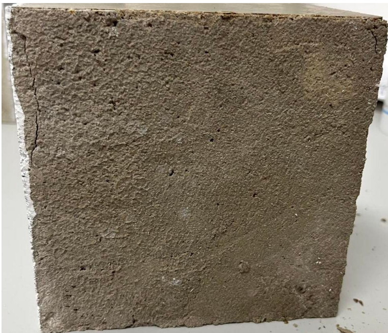
Figur A3.19: Tryckhållfasthetstest utförd på referensprov 2.
