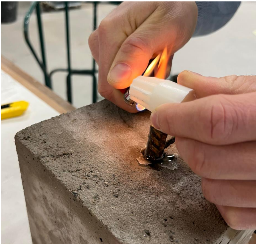
Figur A3.6: Tätning runt armering med stearinljus och tändare.
