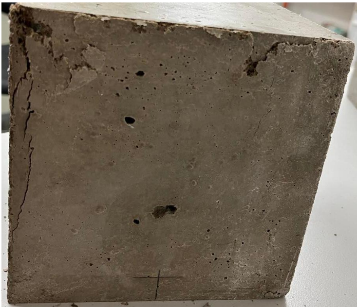
Figur A3.17: Tryckhållfasthetstest utförd på referensprov 2.
