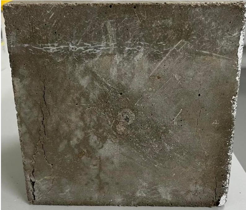
Figur A3.24: Tryckhållfasthetstest utförd på referensprov 4.
