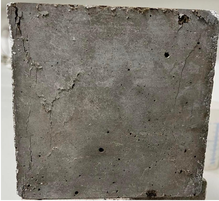
Figur A3.14: Tryckhållfasthetstest utförd på referensprov 1.
