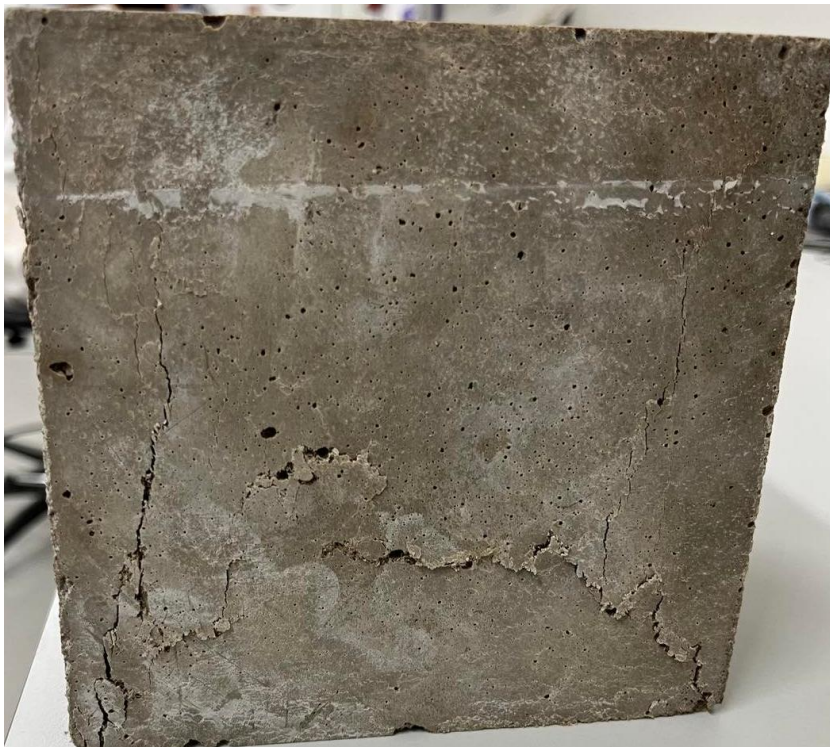
Figur A3.27: Tryckhållfasthetstest utförd på referensprov 4.
