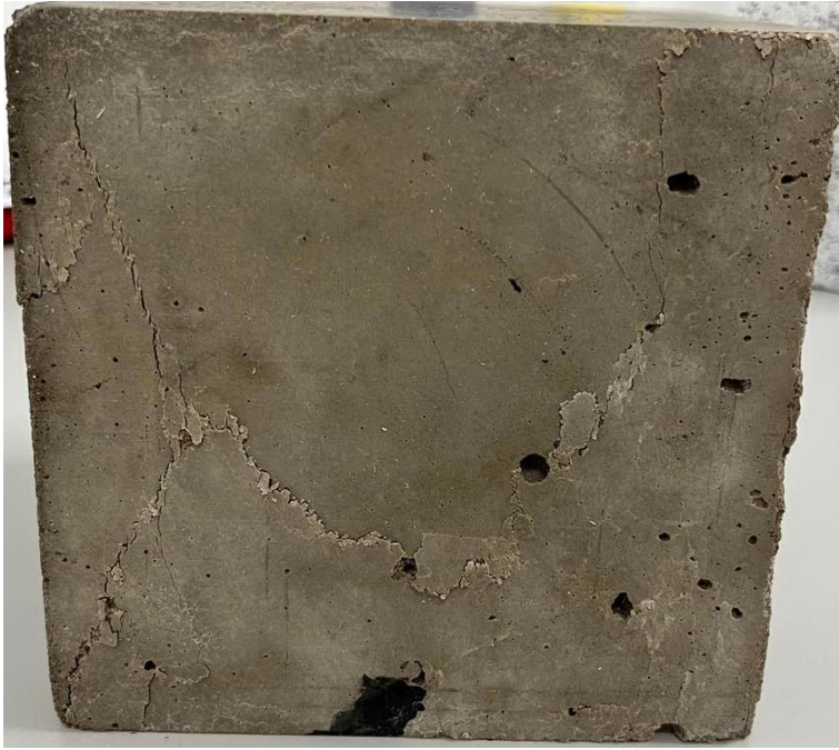
Figur A3.20: Tryckhållfasthetstest utförd på referensprov 3.
