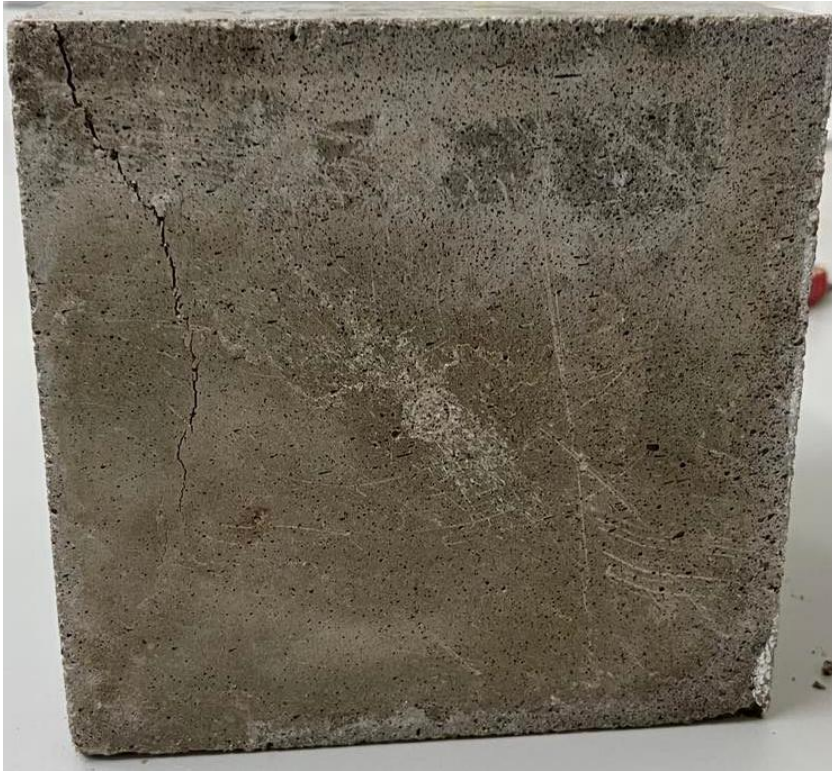
Figur A3.28: Tryckhållfasthetstest utförd på referensprov 5.
