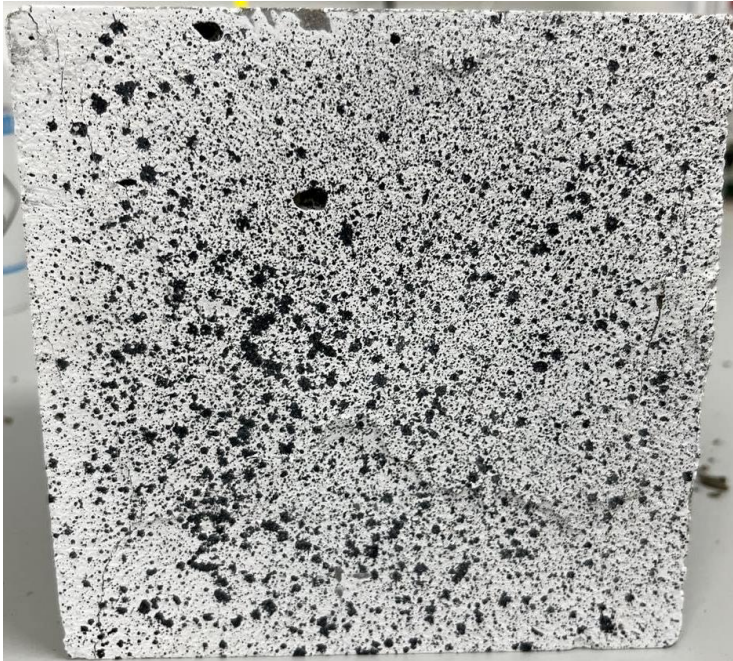
Figur A3.16: Tryckhållfasthetstest utförd på referensprov 2.
