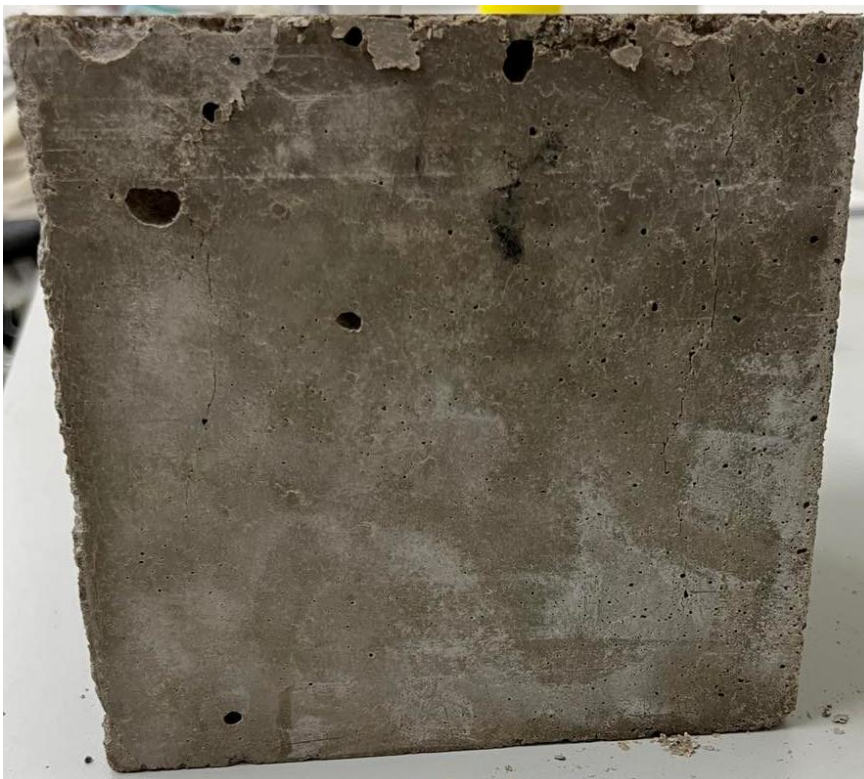
Figur A3.31: Tryckhållfasthetstest utförd på referensprov 5.
