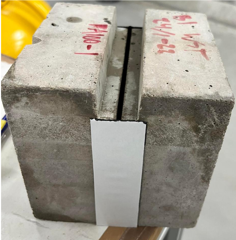
Figur 3.4: Tätning av sprickor med butylband.
