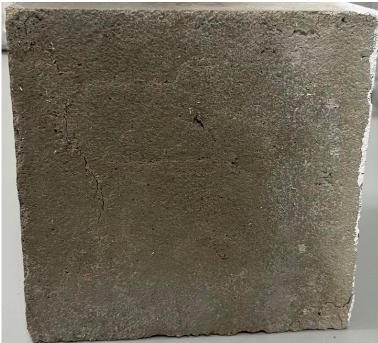
Figur A3.21: Tryckhållfasthetstest utförd på referensprov 3.
