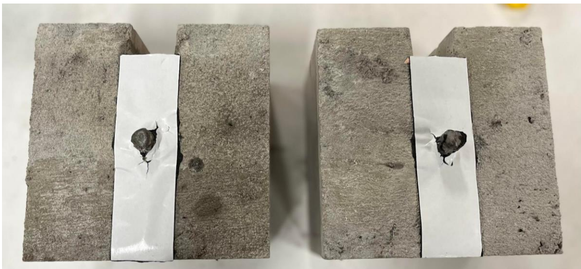
Figur A3.8: Tätning av sprickor med butylband.
