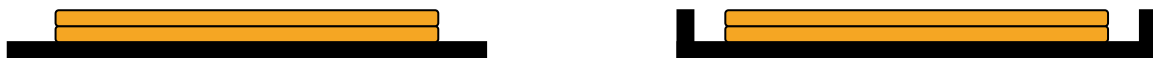
Figur 16: Förenklat tvärsnitt av basmodellen (vänster) och alternativ geometri (höger), med spolarnas lindningar (orange) ovanför ferritplattan (svart).
