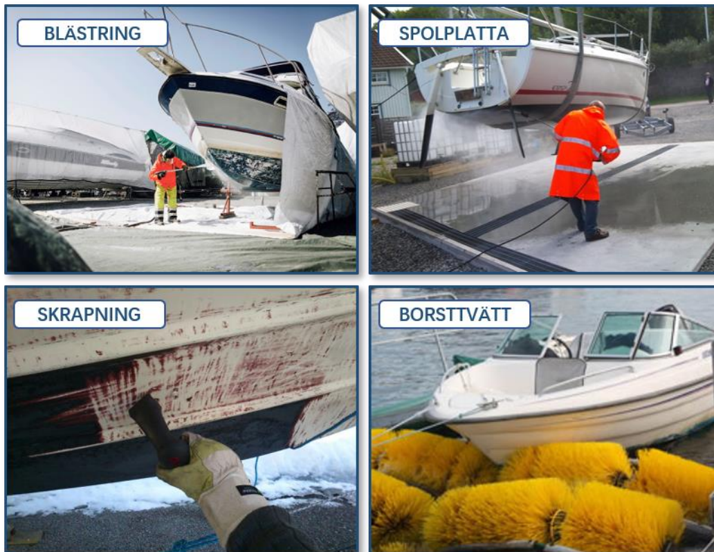
Figur 4: Rengöringsmetoder för borttagning av båtbottnfärg.
