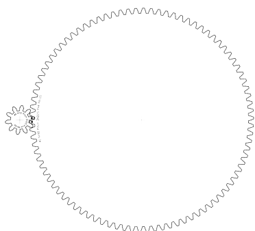
Figur 2.3: Enkel koppling med en 1:9 utväxling. Notera den stora diameterskillnaden på kugghjulen.
