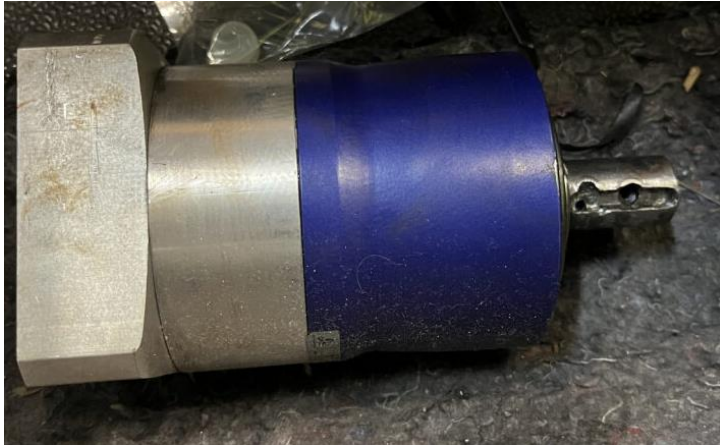
Figur 5. Planetväxel med utslitet kilspår på utgående axel.
