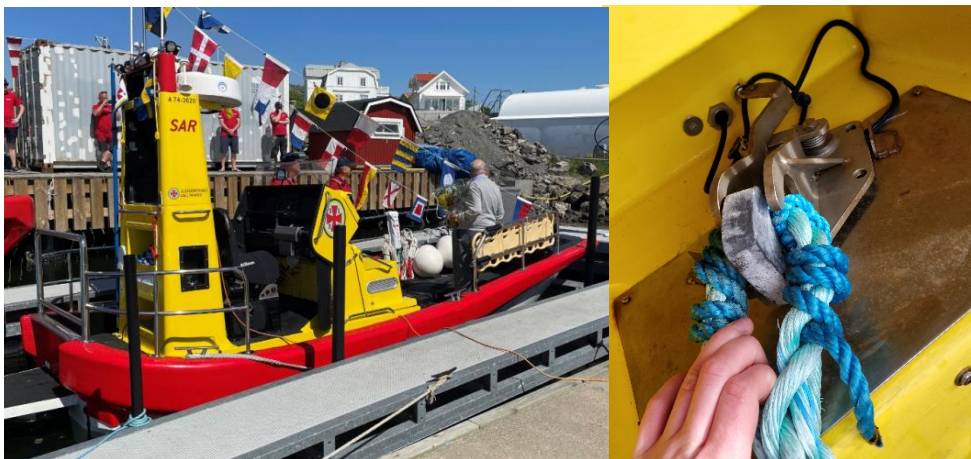
Figur 9: Rescue Birgit Mellgren och båtens bogserkrok. Foto: SSRS och Kristoffer Persson, återgiven med tillstånd.
