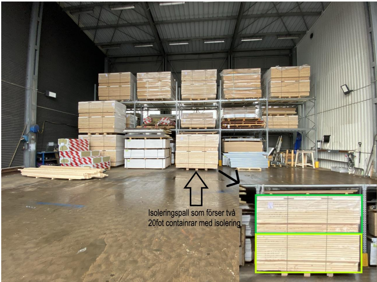
Figur 10 Lager för isolering, varje pall innefattar 2st satser av isolering. 4x2 pallar per våning, varav 3 våningar av stålhyllor. Till vänster om den stora pilen visas en vit isolering och i röd och vit förpackning finns stenullsisolering och båda används i andra produktionsflöden. Framför den till vänster finns träplankor som används i andra produktionsflöden. Längst ner till höger visualiseras ett bord och annat material.
