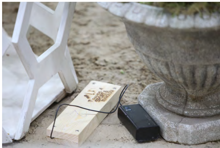
Figur 4: Mätutrustningens träkonsol och powerbank
