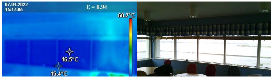
Figur 6.3 Bild av Salen, vy åt NV. OBS. köldbrygga vid fönsterband.
