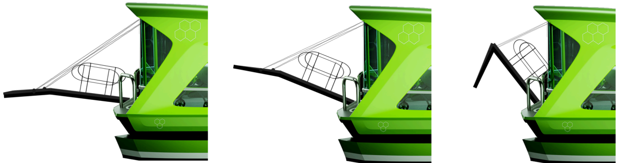
Figur 9. Koncept 3, nedfällbar landgång med vadersystem
