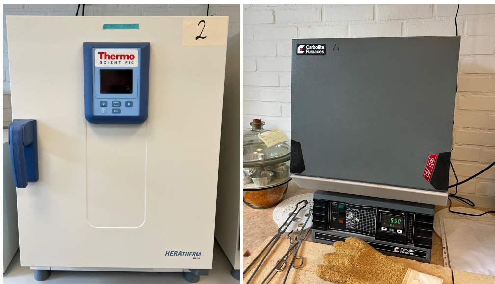
Figur 8. Ugn som användes för torkning vid 105^{\circ}\text{C} till vänster och grafitugn för upphettning till 550^{\circ}\text{C} till höger.
