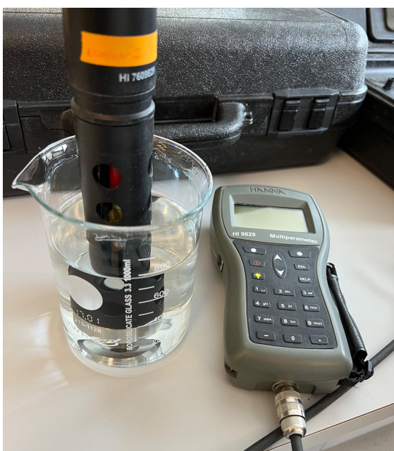
Figur 9. Analys av vattenprov med multinersinstrument [39].
