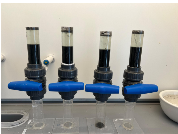
Figur 5. Separationstuber med sediment och KBr-lösning där sedimentation har skett.
