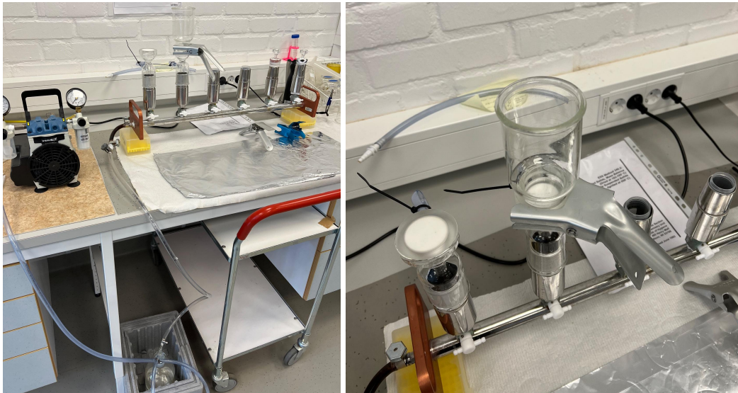
Figur 4. Pumpen för vakuumfiltrering till vänster och närbild på behållaren för filterpapper till höger.
