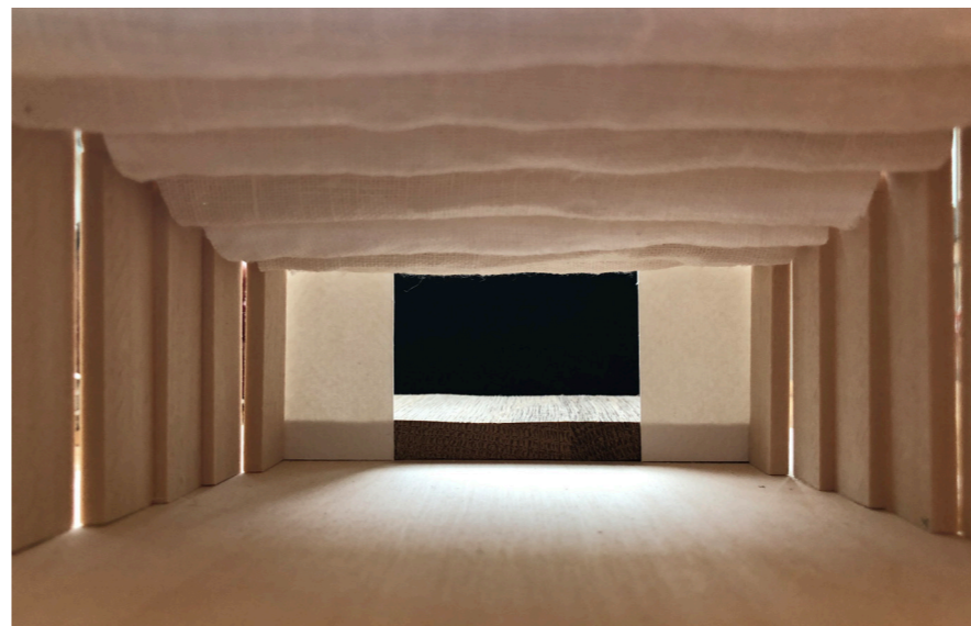
Fysisk modell av auditoriet som visualiserar det vågiga taket och vertikala väggelementen.
