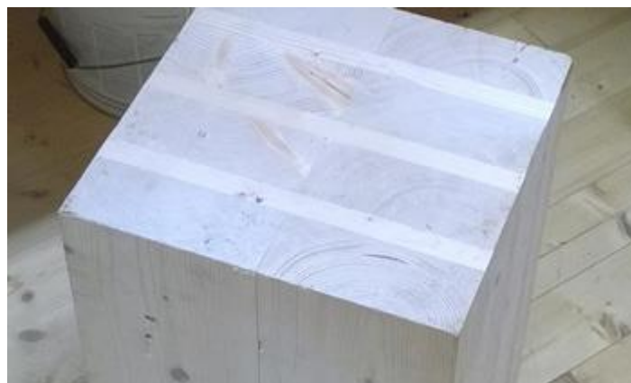
Figur 5. 7-skiktsskiva av KL-trä tillverkad av gran (Svenskt Trä, 2017). Återgiven med tillstånd.
