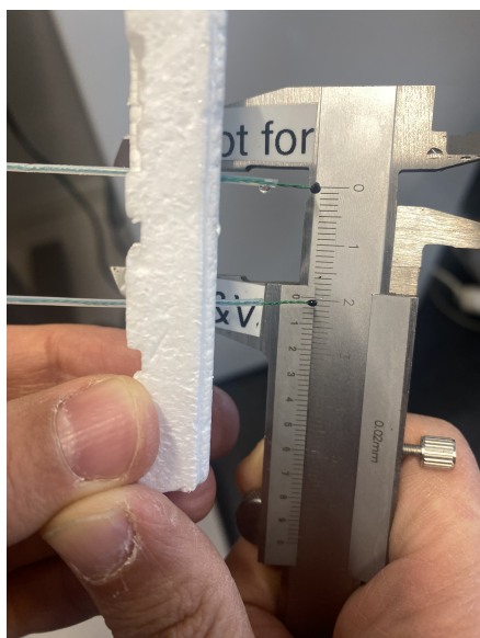
(c) Avståndsmätning med skjutmått.
