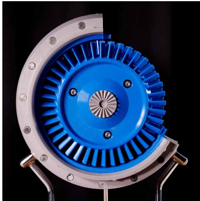
Figur 5.15: Kärnan framifrån. Längs ytterkanten sitter magneter som dockas ihop med magneterna i respektive fläkthölje.
