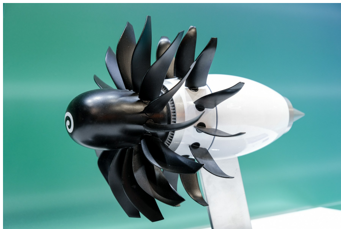
Figur 3.5: Bild av propfanmotorn Rise , Copyright Mamberti, T, Safran. (2023). Rise ,France ; Le Bourget ; Parc des expositions, Paris, https://medialibrary.safran-group.com/Photos/media/433938 .
