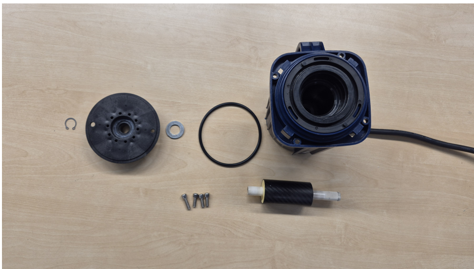
Figur 9: Delar till pump. Namn från vänster överrad: Låsring, platta på axel, bricka, o-ring, pump, skruvar, axel.
