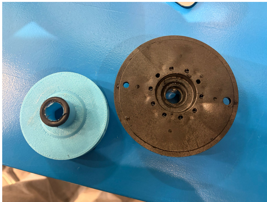
Figur 4: Friktion mellan plattan (svart) monterad på pumpens axel och löphjulet (blå) deformerades plastiskt där svart plast observerades på löphjulet
