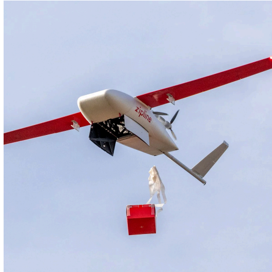
Figur 3.2: Ziplines fixed-wing drönare med öppnat fack och släppt gods [10].
