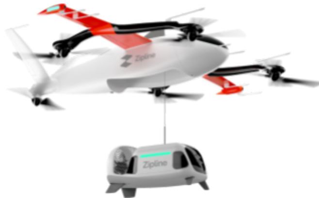
Figur 3.1: Ziplines fixed-wing/multirotor drönare med ned vinschad behållare[10].
