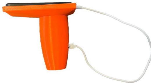
Figur 3.9: 3D-printad modell av en "självscanner" med UWB-tag i handtag och powerbank ovanpå.
