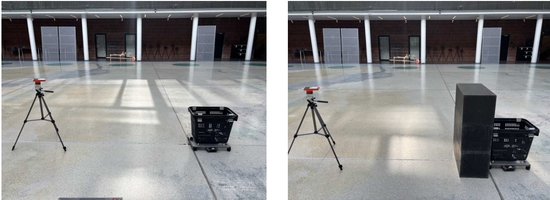
Figur 5.2: Exempel på uppställning för avståndsmätning med hjälp av UWB med LOS (vänster) och NLOS (höger).
