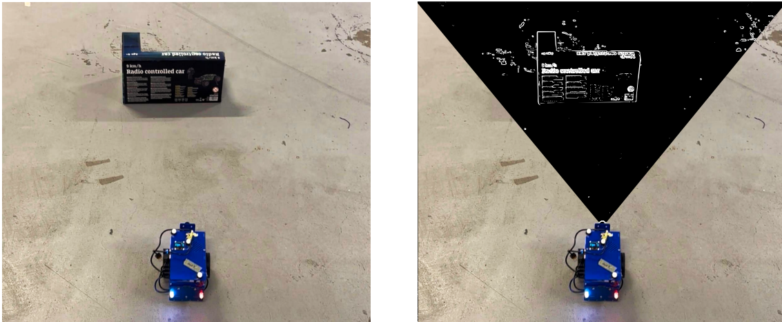
Figur 4.4: Till vänster visas originalbilden och till höger visas resultatet efter Canny-kantdetektion.
