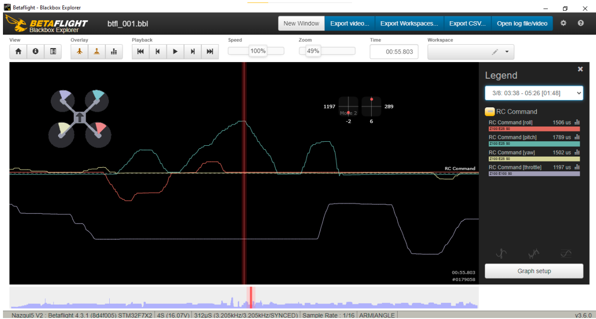
Figur 9. Analys av en drönarflygning och styrsignaler i Betaflight Blackbox Explorer.
