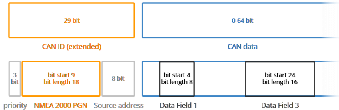
Figur 2. CAN ram för ett NMEA 2000-meddelande. [10]. Återgiven med tillstånd.
