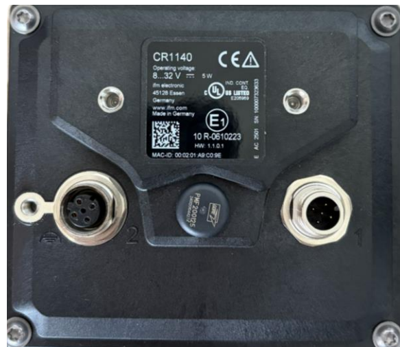
Figur 5. Baksidan av CR1140-displayen. (F rfattarens egen bild).
