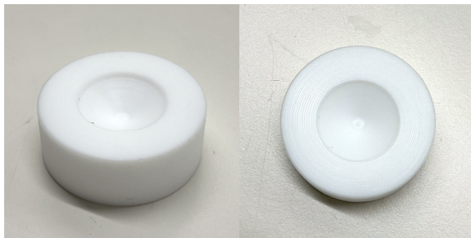
Figur 3.1: Teflonskål som användes vid jämviktsbestämning.
