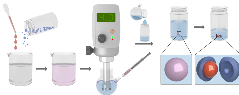
Figur 3.2: Schematisk bild över hur tillverkningen av mikrokapslar går till [3]. Återgiven med tillstånd.
