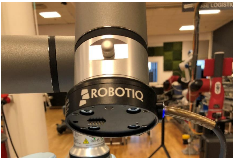
Figur 4: Wrist Camera monterad på UR3.
