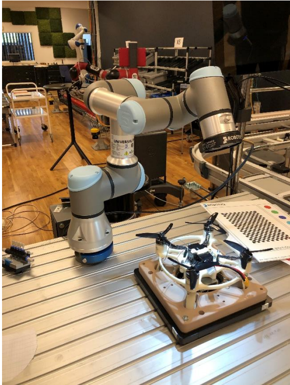
Figur 3: Utrustning för visionsystem bestående av UR3 och Wrist Camera.
