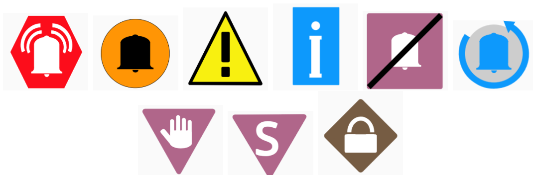
Figur 4.2: Alla flaggor från vänster till höger: Kritiskt larm, larm, varning, information, blockera larm, återställ larm, manuellt läge, simulering, intelock
