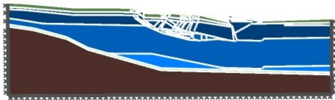
Figur 5.25: Brott för odränerad analys vid hydrostatiskt tryck med säkerhetsfaktorn 1,17. Utbredningen är cirka 55 meter i horisontalld.
