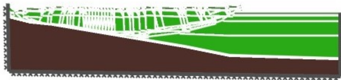
Figur 5.22: Brott för dränerad analys vid hydrostatiskt tryck med säkerhetsfaktorn 7,46. Utbredningen är cirka 205 meter i horisontalled.
