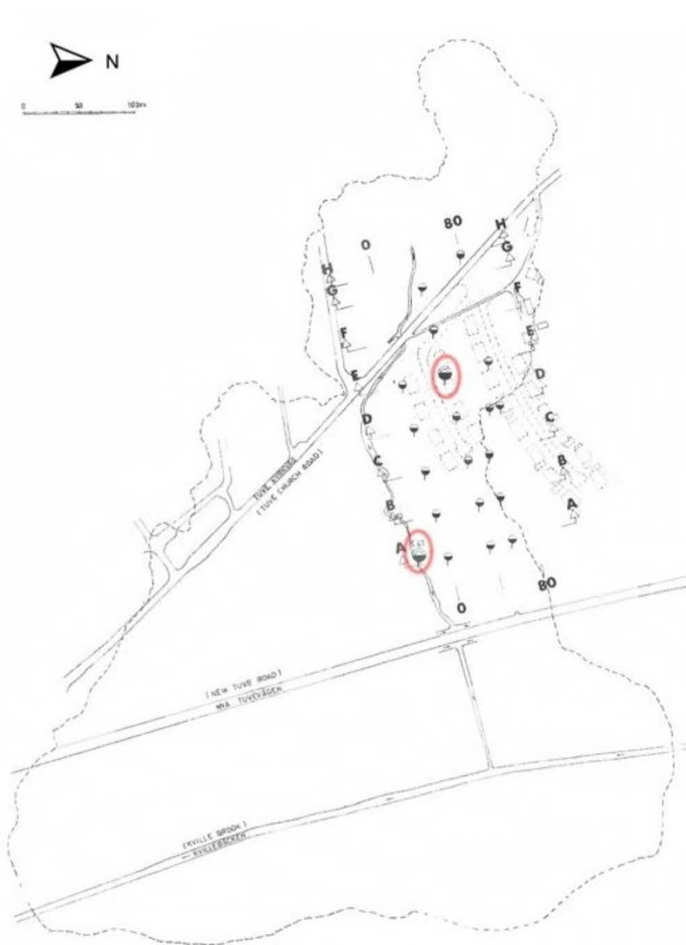
Figur A.1: Borrhålsplacering innan skredet inträffade. I arbetet beaktas de rödmarkerade borrhålen. Från [6]. Förtydligad och återgiven med tillstånd.
