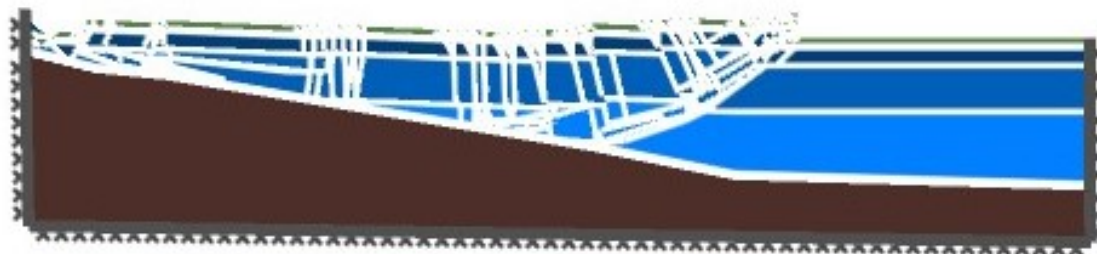
Figur 5.21: Brott för odränerad analys vid hydrostatiskt tryck med säkerhetsfaktorn 2,88. Utbredningen är cirka 214 meter i horisontalled.
