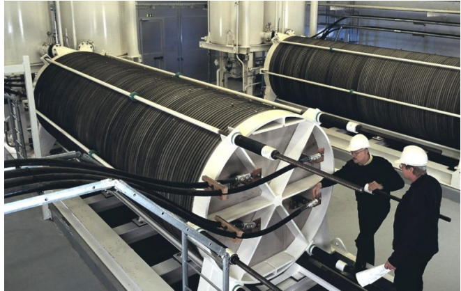
(b) Nel Hydrogen Alkaline Electrolyzer A485 [44].
