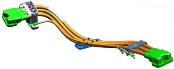
Figur 11. Modell för batterikablage, vänstra fästet är motorfästet och högra är batterifästet, skapad i IPS.
