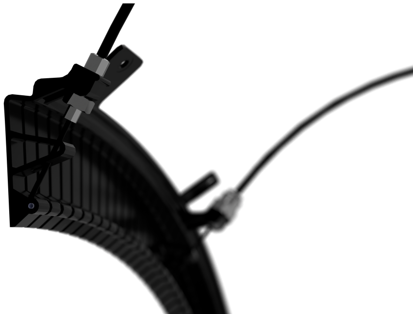
Figur 4.4: Nippelkoppling som fäster PTFE-höljet i finger-gap reducer.
