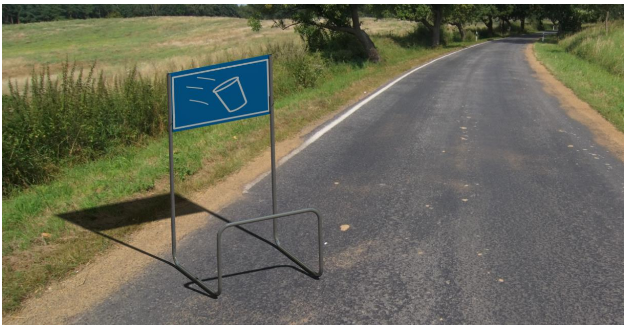
Figur 29. Rendering av det vidareutvecklade konceptet för storsäckshållare med skylt. Bakgrundsbilden är taget från programmet Catia V5
