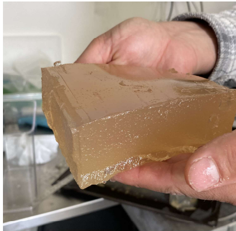
Figur 12: Färdig fantom utskuren till 10\text{ cm} \times 10\text{ cm} \times 4\text{ cm} .
