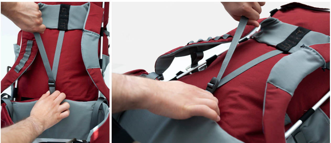
Figur 7.14. Steglös justering av axelockets placering i höjdlöd.
