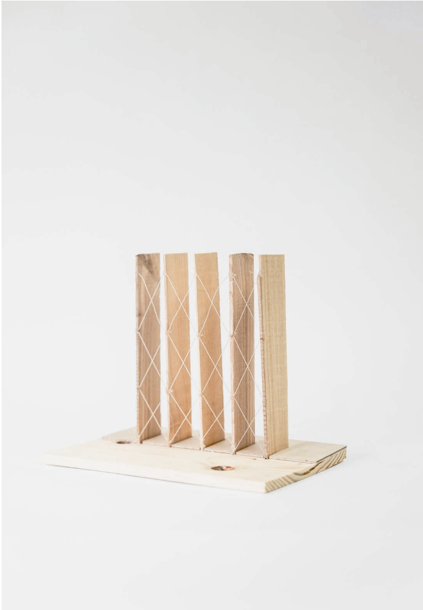
Fysisk modell av tunna djupa pelare med krysstag.
