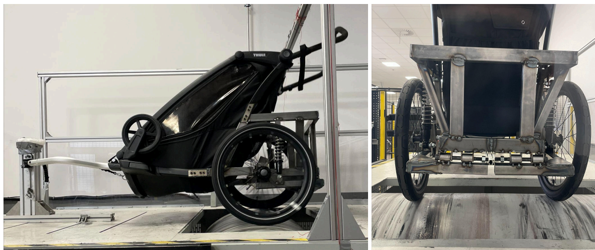
Figur 34 och 35: Prototyp i drumtest maskin
