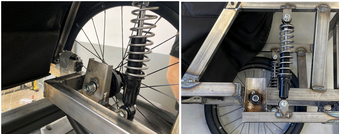
Figur 19 och 20: Hjulaxelns placering i hjulkonsolen
