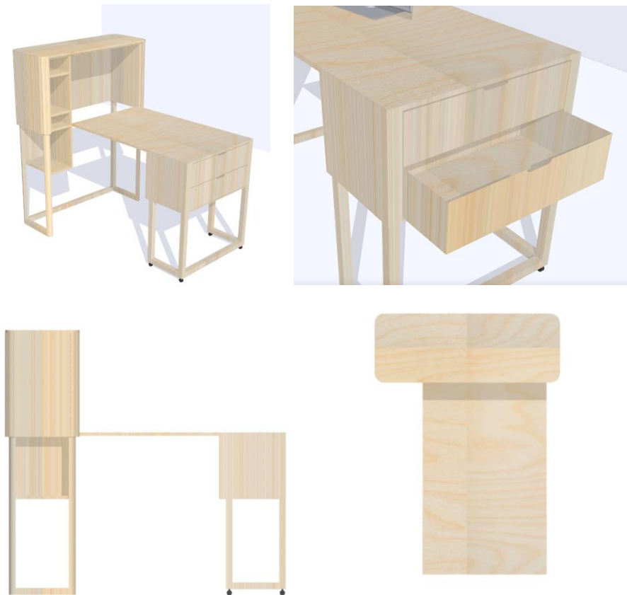
Figur 53: Slutkonceptet, sittande position (perspektiv, utdragen låda, från vänster, ovanifrån)
