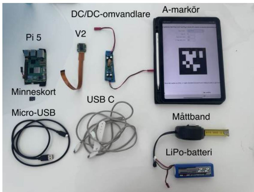
Figur 7.1: Alla komponenter som används för att autonomt kunna utföra distansberäkning.
