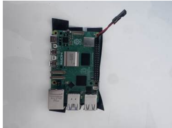
(b) Pi 5 tillsammans med den 3-poliga Dupont-kabel (hona-hona).
