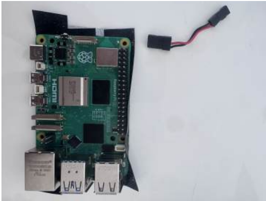
(a) Ensam Pi 5 och 3-polig Dupont-kabel (hona-hona).
