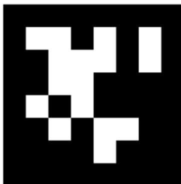
Figur 2.12: Exempel på en A-markör av typ tag36h11 med ID 0, genererad med Python.
