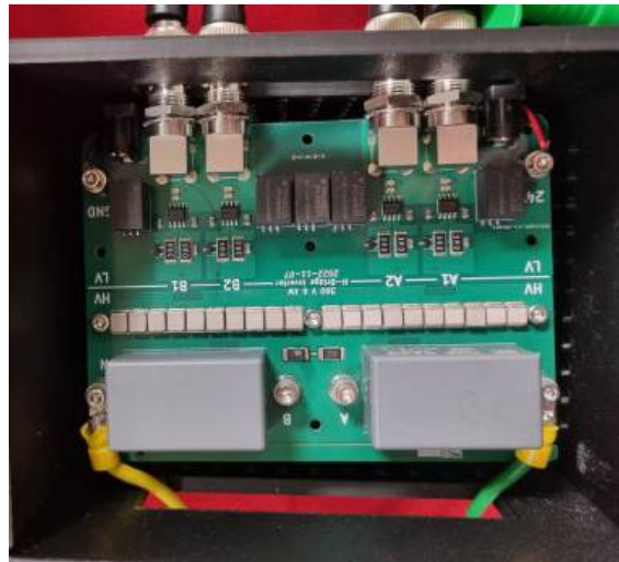
Figur 5.4: Bild på den frekvensomriktare som användes under de tester som utfördes.
