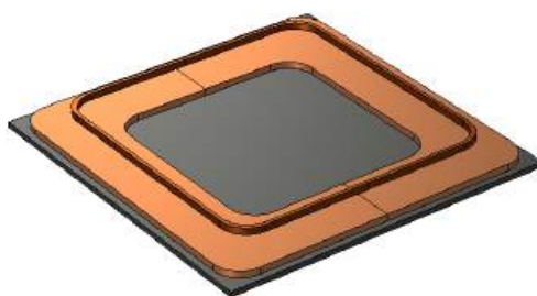
Figur 3.5: Design av primär- och sekundärspolen i COMSOL med en ferritplatta i grått under primärspolen.
