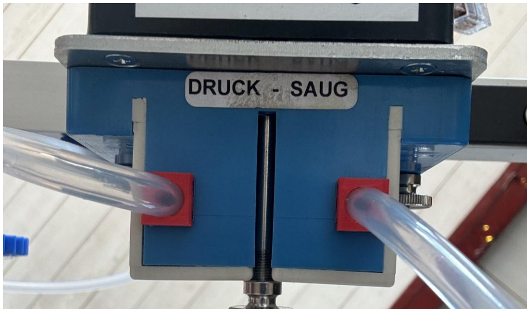
Figur 6.2. Pumphuset med monterade slanghållare.
