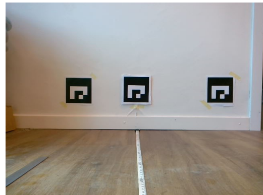
Figur 3.16: Testmätning av avstånd i x -led och z -led för 3 markörer.
