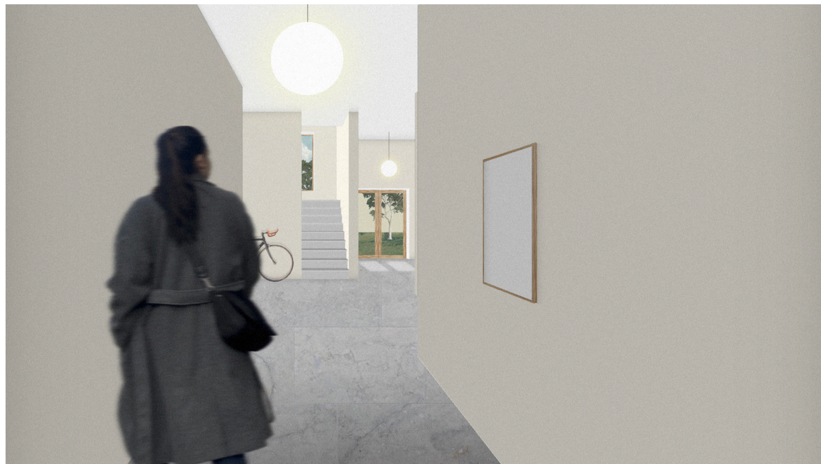
P5. Entrerummet där sockelfasaden får ta ett steg in i byggnaden. Stengolv i slipad kalksten som får fortsätta upp för trappan.
