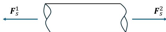
Figur 2.4: Visuell representation av de inre snittkrafter som friläggs vid ett godtyckligt snitt av en belastad lina.
