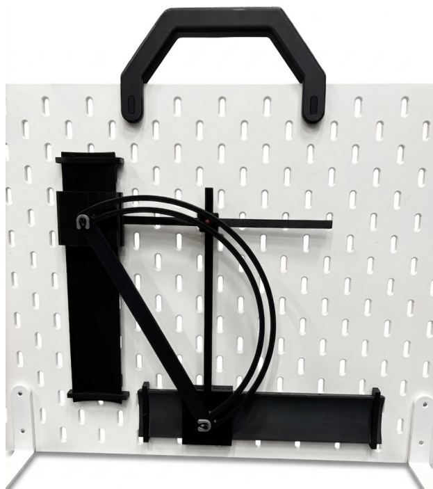
Figur 4.6: Modell för visualisering av momentancentrum monterad på håltavla. Skärningspunkten mellan de två indikatorstängerna lokaliserar momentancentrum för den rörliga huvudstången under hela rörelseförloppet.
