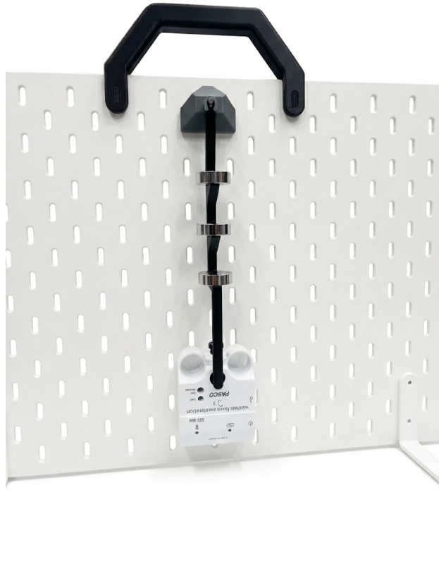
Figur 4.7: Laborationsuppställning för pendelrörelse monterad på håltavla. Bilden visar pendelarmen med det integrerade fästet för accelerometer.
