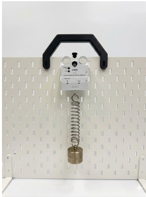
Figur 4.9: Uppställning för fjädersystem monterad på håltavla med det 3D-utskrivna fästet, accelerometern samt upphängning av fjäder och massa
