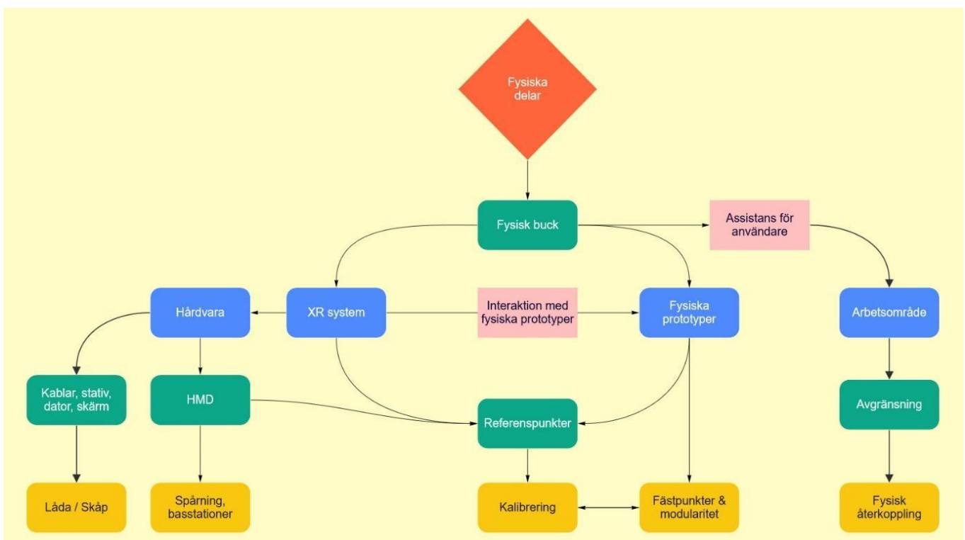
Figur 9: Fysiska delar kommer alltid ingå i ett immersivt system, framförallt hårdvaran som krävs för att använda systemet. Utöver det behöver man också ta hänsyn till arbetsområde, och om andra delar behövs, som fysiska komponenter eller attrapper.
