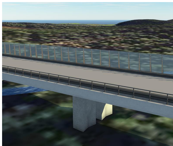
Figur 6.10 Iterativ justering av bropelare tills rätt höjd uppnåtts.
