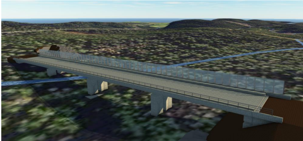
Figur 6.2 Tilldelad Revit-modell exporterat till .fbx-format och vidare importerad samt placerad i InfraWorks 360.
