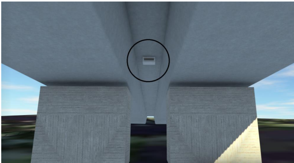
Figur 6.11 Brolager som hamnat i centrum av vår helgjutna betongöverbyggnad.
