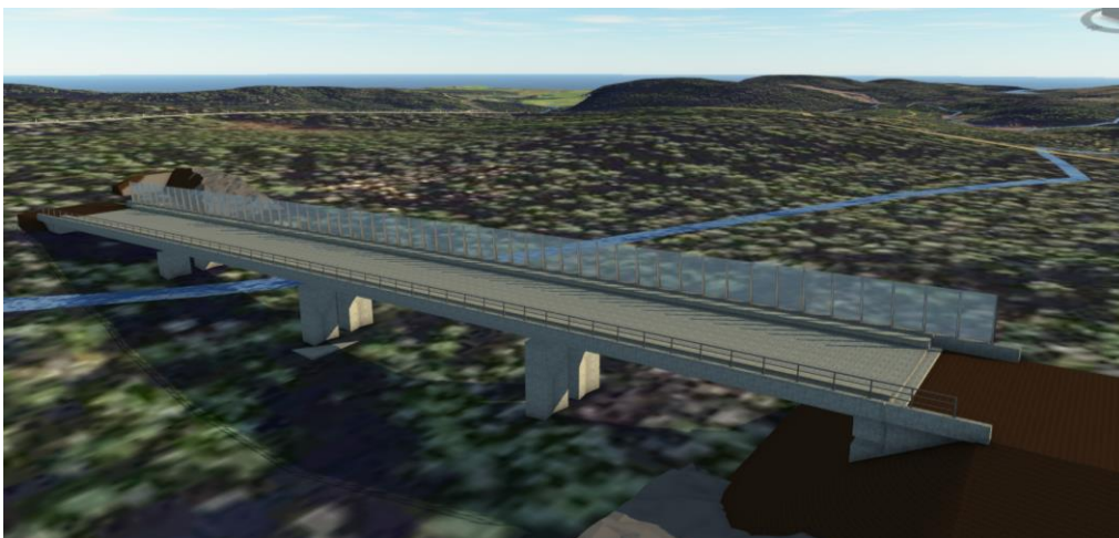
Figur 6.12 Ursprungliga bron som var modellerad i Revit och i figuren importerad och placerad i InfraWorks 360.
