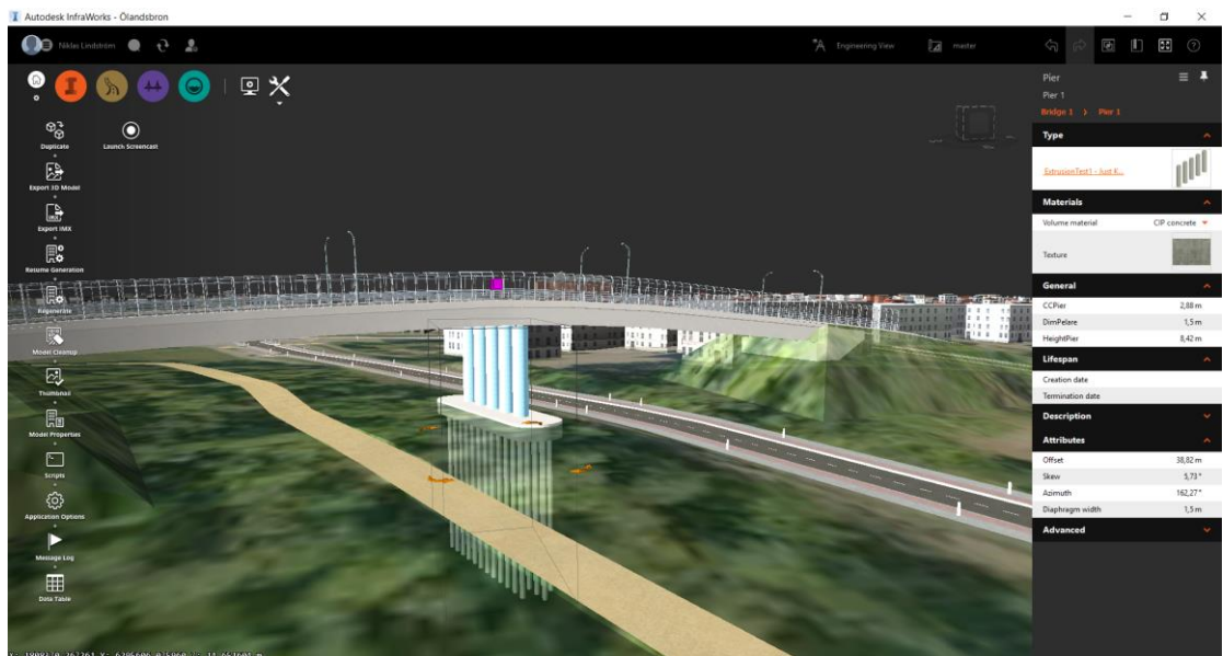
Figur 1.6 Importerade pelare kan nu väljas som Type och justeras enligt exporterade nyckeldimensioner i listan till höger.
