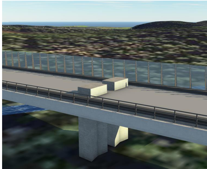
Figur 6.9 Importerade bropelare som inte anpassar sig till överbyggnaden.
