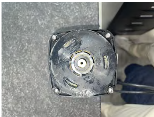
Figur 4.1: Vy av motor med borttaget lock, vita axeln träs löphjul på.
