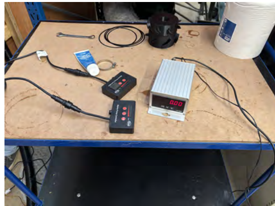
(b) Elektronik, motorhastighetsreglerare och mätinstrument i test 2.
