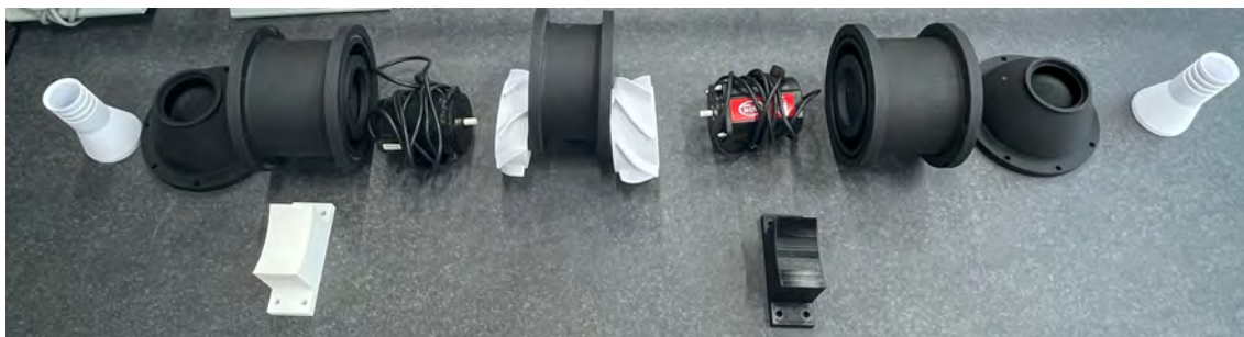
Figur 4.3: Resultat av 3D-utskrifter placerat i systemordning.
