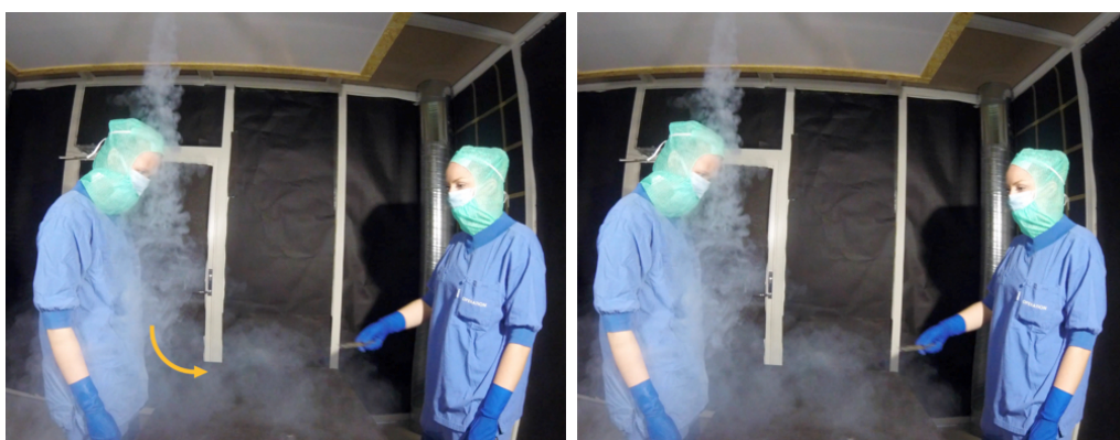
Figur 4.3: Rörelser från operationssjuksköterska B häver virvlar, luften strömmar ut över uppdukningbord och uppdukade instrument.
