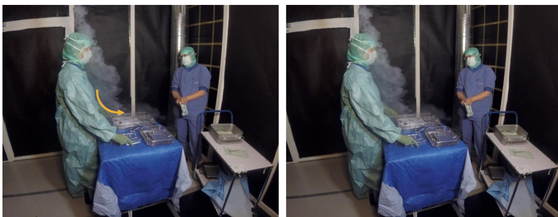
Figur 4.10: Luft som tidigare strömmat i virvlar vid operationssjuksköterska B, strömmar ut över uppdukningbord och instrument.
