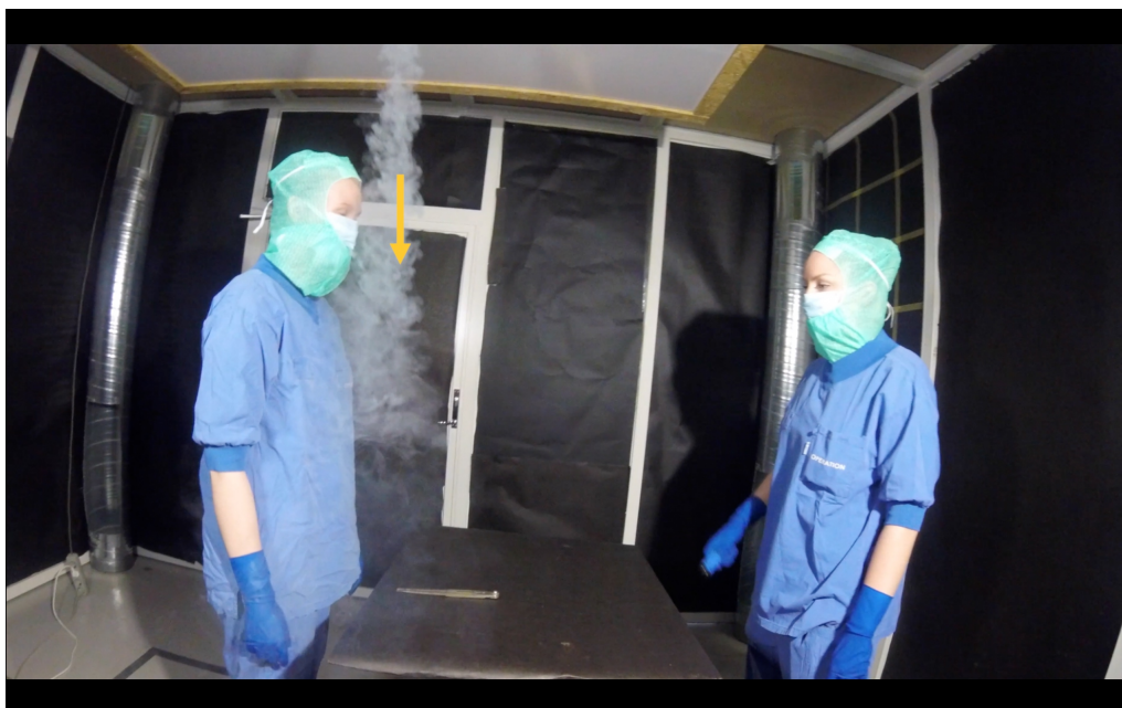
Figur 4.1: Tilluften flödar vertikalt från LAF-taket mot operationssjuksköterska B.
