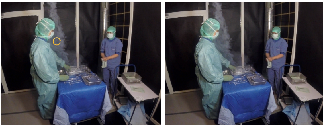
Figur 4.9: Virvlar förekommer i anslutning till operationssjuksköterska B.
