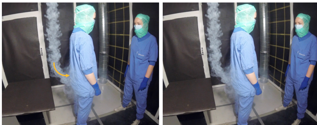
Figur 4.4: Luftflödet strömmar mot operationssjuksköterska B, bort från uppdukningsbordet.
