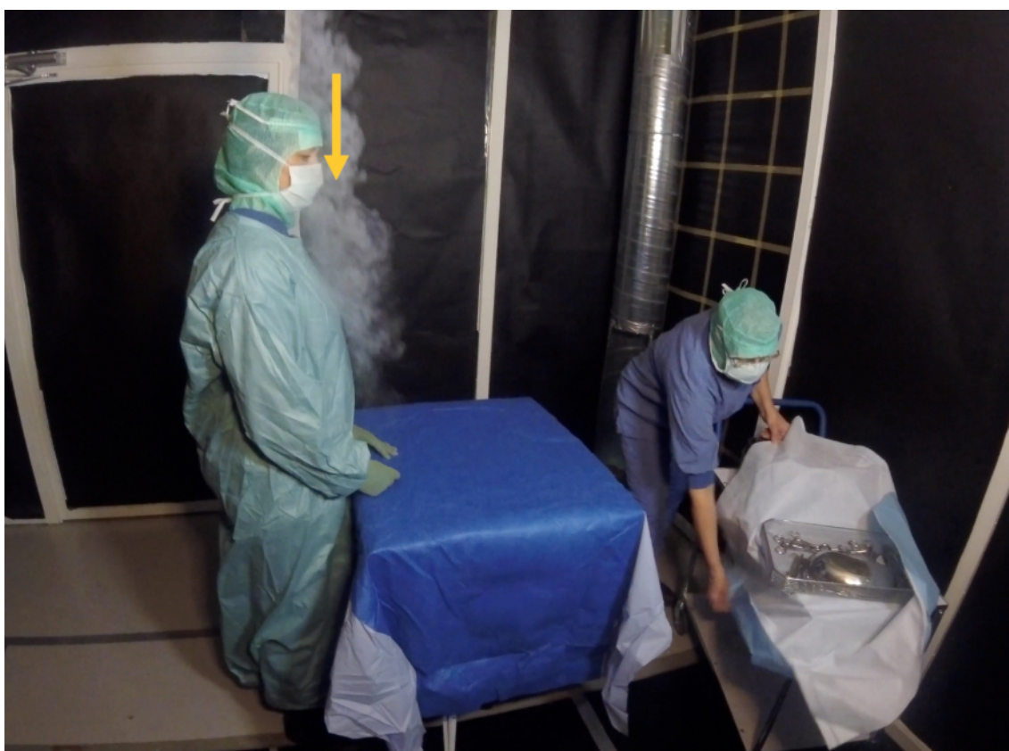
Figur 4.8: Tilluften flödar vertikalt från LAF-taket mot operationssjuksköterska B.
