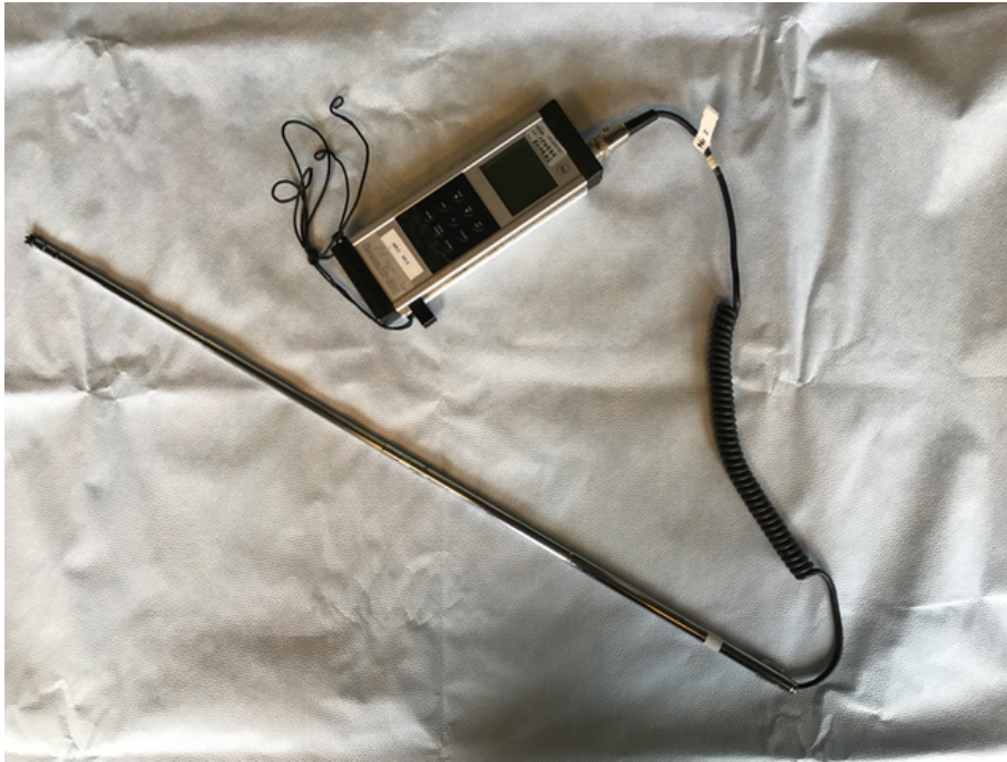
Figur 3.8: Mätinstrument SwemaAir 300 med tillhörande givare för mätning av lufthastighet.
