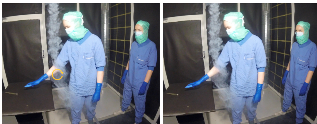
Figur 4.5: Luften strömmar i virvlar och bryts utan att flöda mot uppdukningsbordet.
