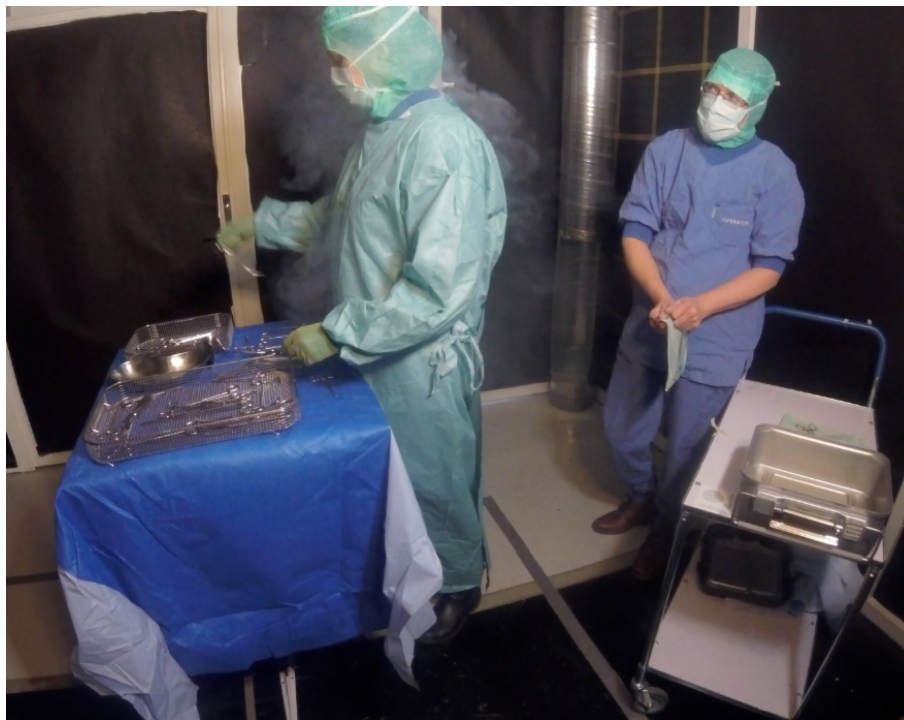
Figur 4.13: Inget avstånd mellan operationssjuksköterska B och uppdukningbordet råder, rök i luftens strömning återfinns vid uppdukade instrument.
