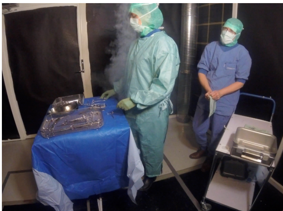
Figur 4.14: Operationssjuksköterska B har lämnat ett avstånd till uppdukningbordet, luften strömmar i detta mellanrum utan att komma i kontakt med uppdukade instrument.
