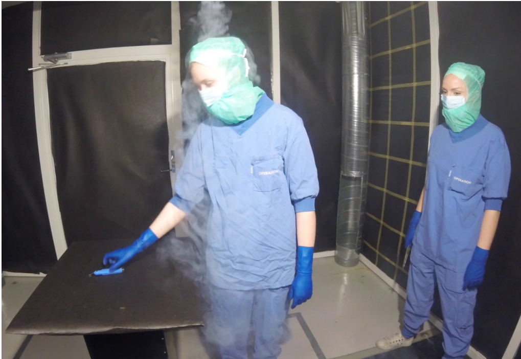
Figur 4.6: Operationssjuksköterska B står i direkt anslutning till uppdukningsbordet, rök i luftens flöde befinner sig på detta bord.
