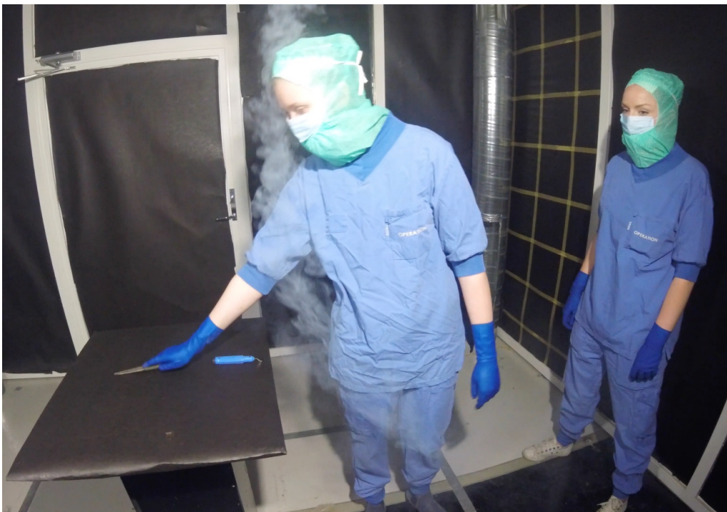
Figur 4.7: Ett mellanrum återfinns mellan uppdukningsbord och operationssjuksköterska B, luften strömmar ej ut över bordet.
