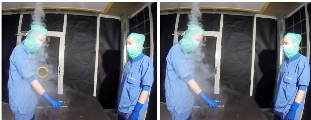
Figur 4.2: Luften strömmar i virvlar vid operationssjuksköterska B.
