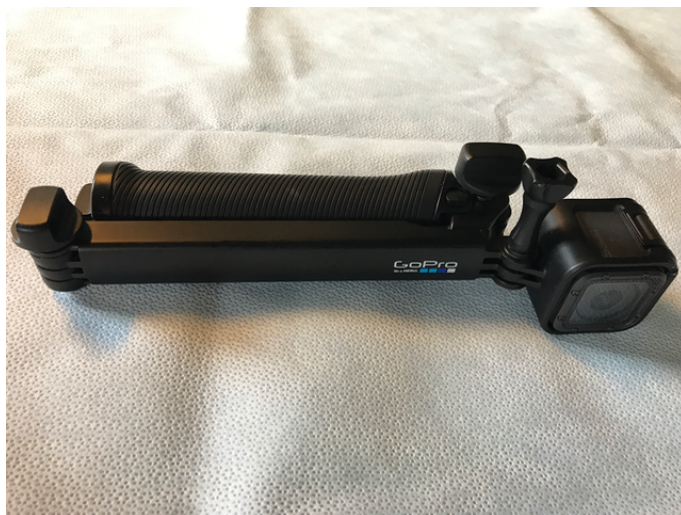
Figur 3.10: Videokamera GoPro Hero 5 Session monterad på stativ användes för att dokumentera luftens rörelsemönster under testförsöken.
