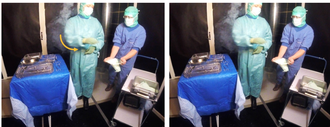
Figur 4.12: Luften flödar ut från den sterila zonen, längs armrörelser som operationssjuksköterska B utför.
