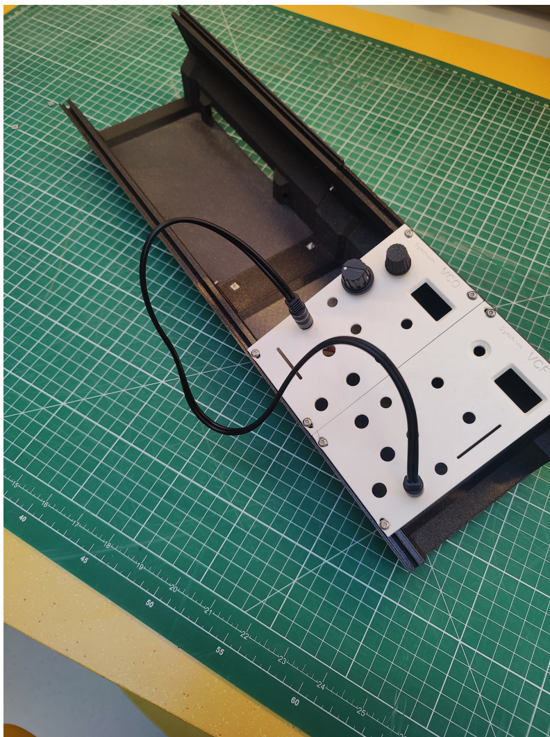
Figur 3.8: 3D-printat chassi med två modulpaneler fastmonterade.
