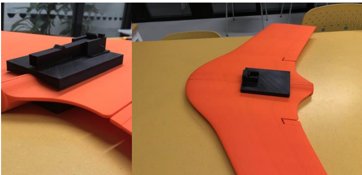
Figur 69. Krokprototyp på testdrönare (PLA).
