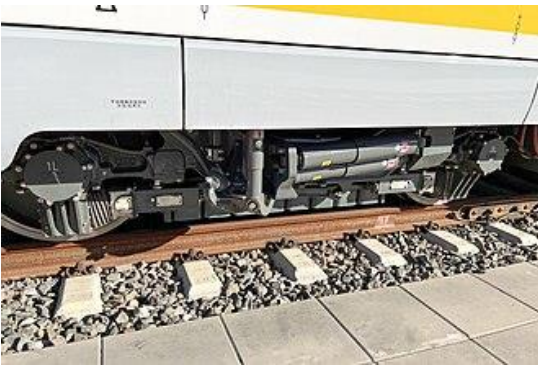
Figur 19. Virvelströmsbroms i ett tåg.
