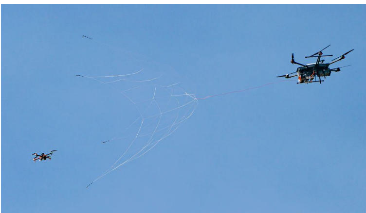
Figur 23. Dronehunter F700 skjuter ut ett fångstnät mot en annan drönare.
