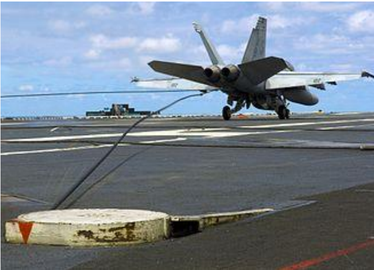
Figur 62. F/A-18 landar med hjälp av en gripvajer på ett hangarfartyg.
