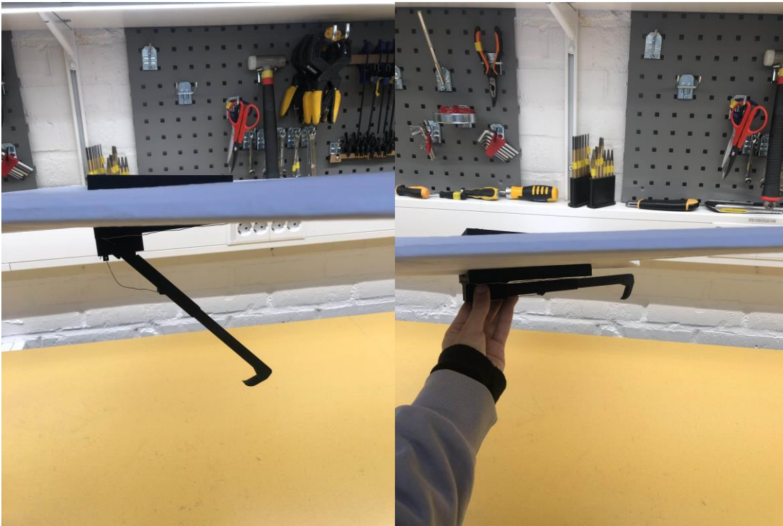
Figur 70. Krokprototyp fäst på en testdrönare (polyuretanskum) i utvikt (vänster) och hopvikt (höger) läge.
