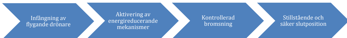
Figur 2. Schematisk inbromsningsprocess av drönare.
