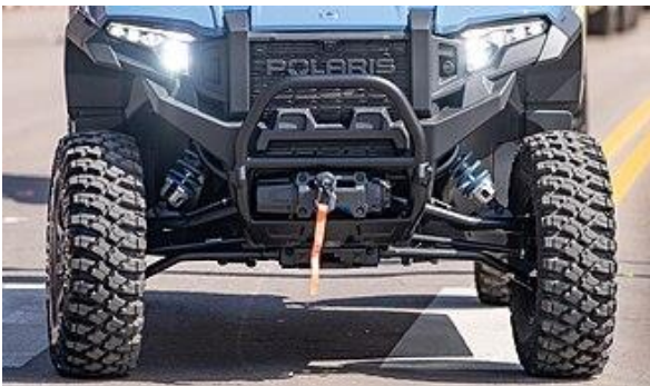
Figur 17. Polaris ATV elektrisk vinsch med krok.
