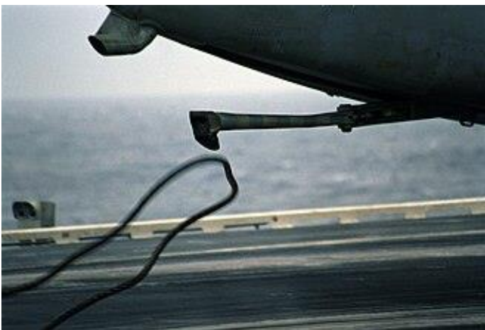
Figur 56. Kroken som används på militärflygplanet F/A-18 för att haka i gripvajern i ett Mk-7-bromssystem på ett hangarfartyg.
