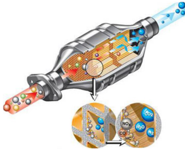
Figur 2.3 - Illustration av en katalysator där kväveoxiderna flödar in och ut kommer kvävgas [15].
