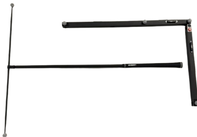
Figur 3.2: Kalibreringsverktyg för MoCap systemet. En kolfiberstav (till vänster) med två markörer samt en L-ram (till höger) med totalt fyra markörer.
