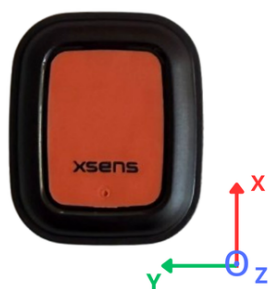
Figur 3.5: Bild av IMU-sensorerna som används under samtliga mätningar. Sensorns interna koordinatsystem är definierat.
