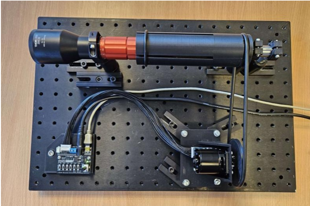
Figur 3.11: ZBE32 monterad i det uppbyggda mätverktyget
