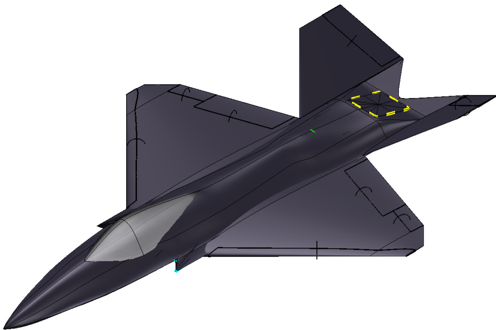
Figur 4.2: Översikt av den slutliga OpenVSP-modellen. Figuren visar flygplanets integrerade flygkropp, huvudvinge, V-tail, luftintag och bakre utblås.
